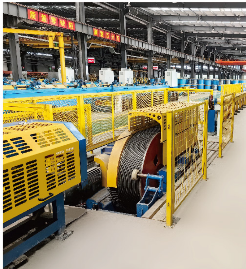
在线预张拉装置（用于电梯钢丝绳的生产） Stretching unit for the manufacture of elevator rope
